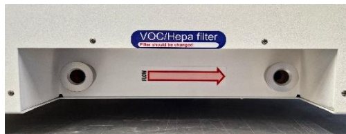
Figure 12.1 La flèche de flux sur l'incubateur Mini MIRI® Dry multiroom FIV
