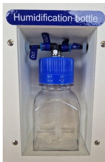
Figure 22.1 Raccordement du tube sur la bouteille d'humidification et l'incubateur Mini MIRI® Humidity multiroom FIV
