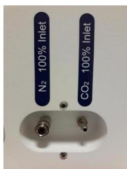
Figure 11.1 Raccords du gaz à l'arrière des incubateurs FIV à compartiments Mini MIRI® Dry et incubateurs FIV à compartiments Mini MIRI® Humidity
